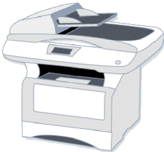
Figure 2.2.3.1.1.c – Une imprimante multifonctions : c'est un poly-système composé d'une imprimante, d'un scanner et d'un fax.
