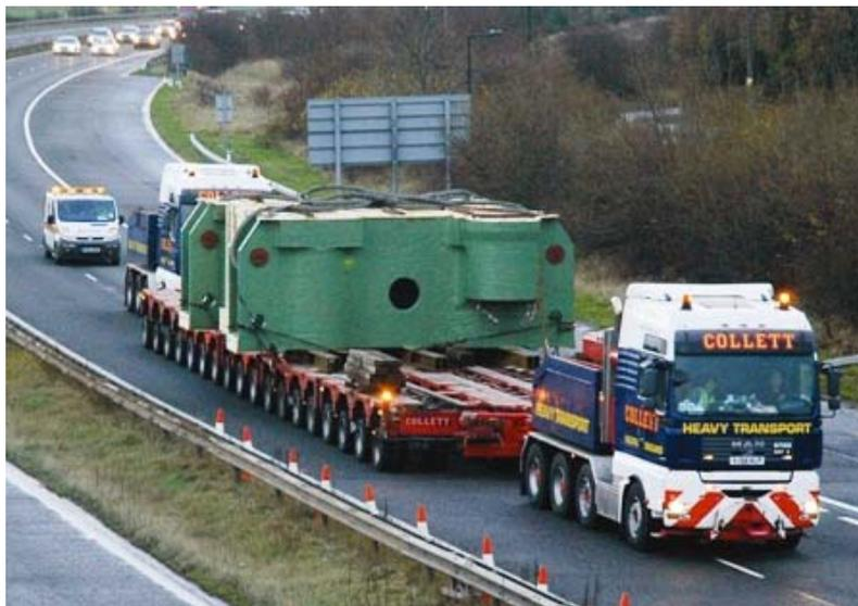
Figure 2.2.3.1.1.b – Sur cette photo, une remorque avec des axes développés en poly-système.
