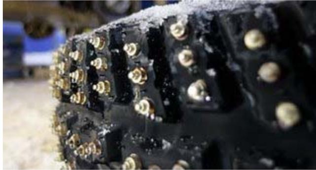
Figure 2.2.1.1.2.d – Exemple d'application du Standard 1-1-2 à des pneus neige (additif interne = clous).
