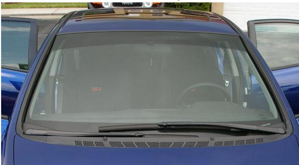
Figure 2.2.1.1.8.1.c – La bande pare-soleil est visible sur le haut du pare-brise : on peut voir à travers elle, mais le soleil ne dérange plus car la bande pare-soleil est plus foncée que le verre transparent du pare-brise.
