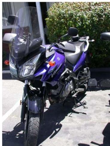
Figure 2.2.3.1.2 – Sur la photo, on voit les deux béquilles : la première (béquille centrale) sur laquelle repose la moto, la deuxième qui évite que la première se ferme.
