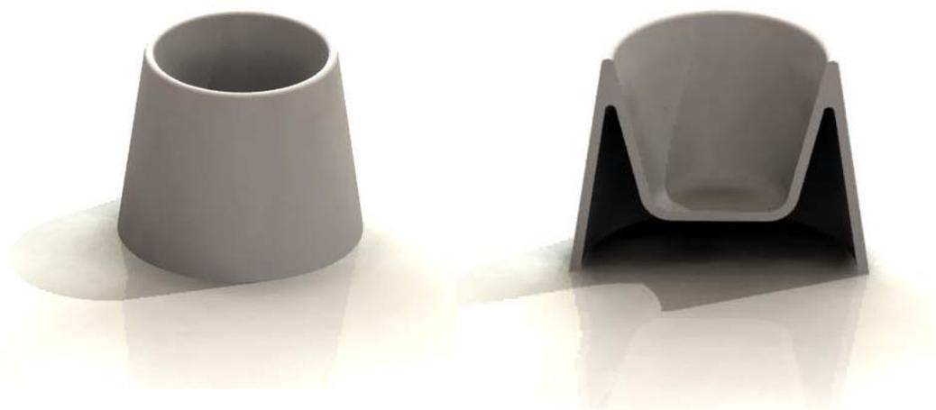
Figure 2.2.5.1.1.c – Une tasse de café qui ne brûle pas les doigts. À droite, sa coupe transversale.
