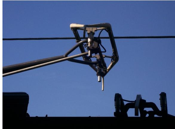
Fig. 5.2. Le pantographe d'un TGV actuel
