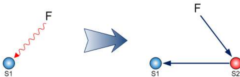
Abb. 2.2.1.2.3.a – STANDARD 1-2-3: Beseitigung eines schädlichen Effekts eines Feldes
