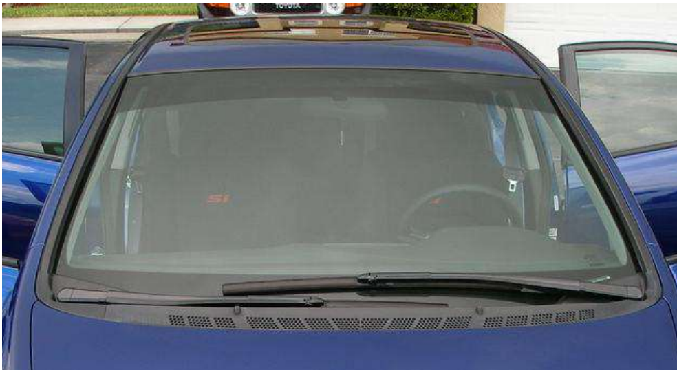
Abb. 2.2.1.1.8.1.c – an der Oberkante der Windschutzscheibe ist die Sonnenblende sichtbar; sie lässt die Personen durchschauen, aber die Sonne ist nicht mehr lästig, weil sie dunkler als das durchsichtige Glas der Windschutzscheibe ist.
