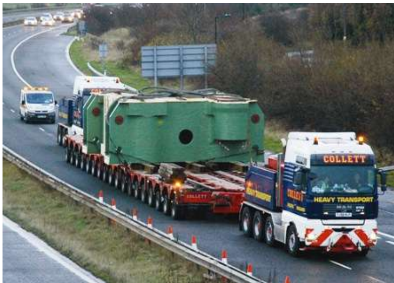
Abb. 2.2.3.1.1.b – Anhänger mit in Richtung eines Poly-Systems entwickelten Achsen
