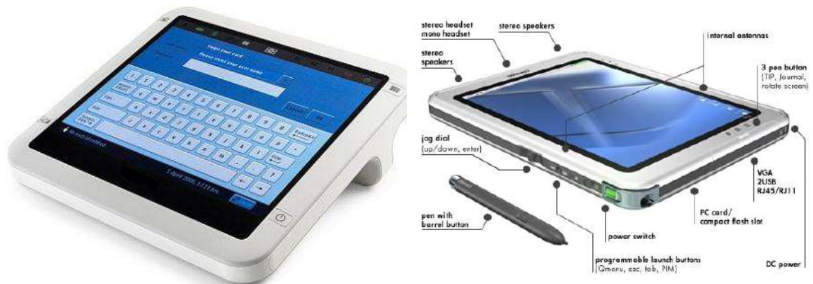
Abb. 2.2.3.1.4.c – die neueste Generation tragbarer Tablet PCs: alle Eingabefunktionen werden auf dem Touchscreen Monitor ausgeführt.
