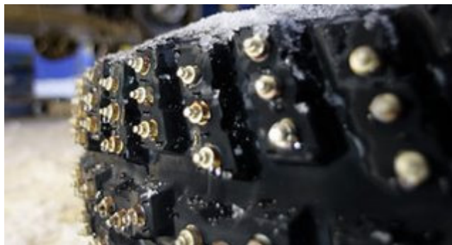
Fig. 2.2.1.1.2.d – applicazione esemplificativa dello Standard 1.1.2 alle ruote da neve (additivi interni = chiodi)
