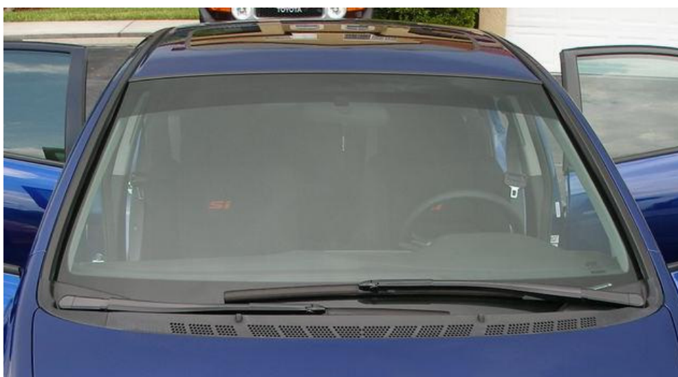
Fig. 2.2.1.1.8.1.c – nella parte superiore del parabrezza è visibile la fascia parasole; ci permette di vedere attraverso ma il sole non è più abbagliante poiché la fascia è più scura del vetro trasparente
