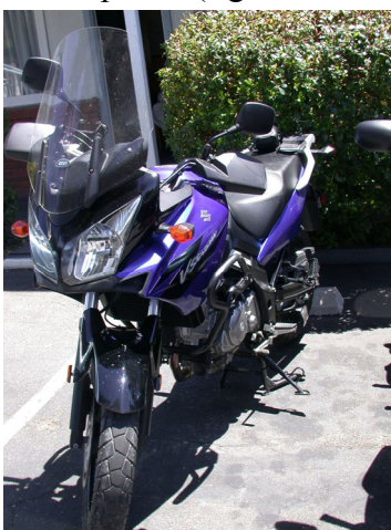
Fig. 2.2.3.1.2 – in figura i due cavalletti: il primo (il cavalletto centrale) sorregge la moto, mentre il secondo impedisce la chiusura del primo
