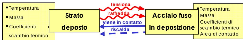
Figura 4.3.25: Azioni tra strato deposto e materiale fuso in deposizione, con i relativi parametri.
