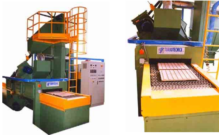
Figura 4.2.12: Esempio di granigliatrice a passaggio continuo
