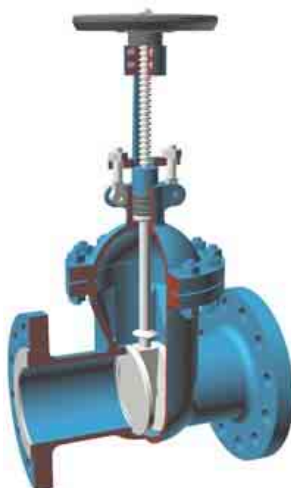
Figura 4.2.3: Esempio di valvola a saracinesca
